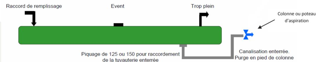
La capacité de la réserve doit être indiquée sur le côté de la réserve accessible aux engins de secours. Les bâches à eau régulièrement soumises au gel doivent être surdimensionnées pour prendre en compte la gangue périphérique non utilisable.
